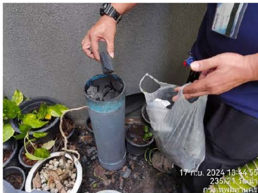
เจ้าหน้าที่เปลี่ยนถ่านตัวกลางระบบมีเทน และ Aerosol
